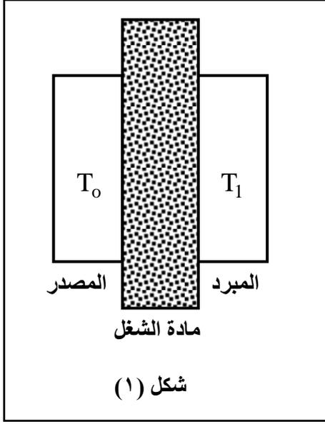
ولما كانت عملية نزع الحرارة من جسم عن طريق ملامسته لجسم آخر درجة حرارته أقل لا ينتج عنها شغل ميكانيكي إذن أفضل طريقة للحصول على شغل ميكانيكي أثناء انتقال الحرارة من المصدر إلى المبرد هي أن يتم انتقال الحرارة من المصدر إلى مادة الشغل ثم انتقال الحرارة من مادة الشغل إلى المبرد بدون فارق بين درجتي حرارتهما. معنى
